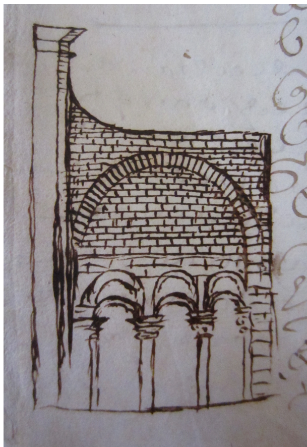
Fig. 1. Dibujo con detalle de un contrafuerte en el exterior de la nave coral, sobre la arquería del interior del edificio. Juan de Ochoa, 1598. AHPC. Protocolos Notariales. Oficio 22. Alonso Rodríguez de la Cruz. 12422-P, fol. 380v y 381r.
